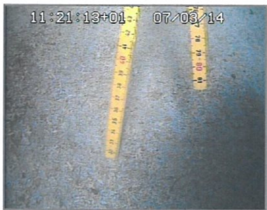
Figur 7-3: Kontroll av mektighet på tildekkingen under kaier. Bilde: SJ Dykk AS.
