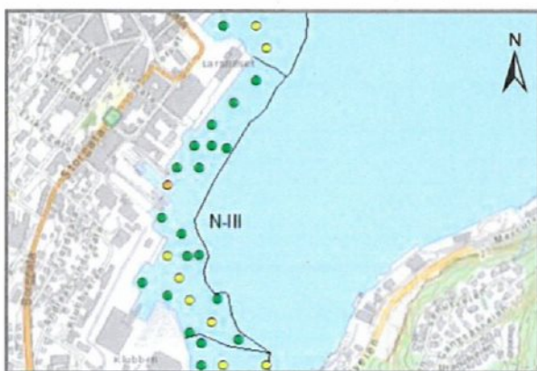
Figur 8-3: Høyeste tilstandsklasse (9) etter tiltak (mudring og tildekking) i N-III for de prioriterte miljøgiftene samlet. Kartet er utdrag fra tegning nr. 711266-RIGm-TEG-015.
